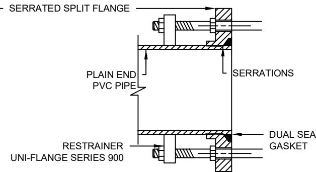
**FLANGE JOINT UNI-FLANGE SERIES 900 RESTRAINER
